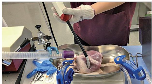
図1 考案した循環モデルによる焼灼実験環境
