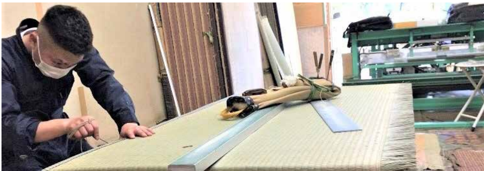
畳の張替え作業をする反頭さん。畳縁を合わせ、畳表を裁断し、畳縁を折り返して仕上げていく
