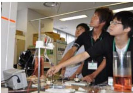
人工心臓装置。空気圧で動作する拍動型ポンプ(心臓)が、チューブとタンク(全身の血管)につながっている。ポンプが送り出す液体(血液)は、チューブとタンクを経て、再びポンプに戻る(循環)。ポンプの動作状態などを変え、循環する液体の圧力(血圧)への影響を理解する。嶋津研究室で作ったオリジナルの装置。
