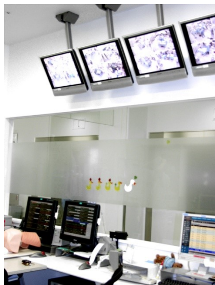
麻酔管理室:各手術室の生体監視モニターを一覧できるセントラルモニターと室内監視モニターのほかに、各部屋の麻酔記録も一覧できる監視装置を備えている。
